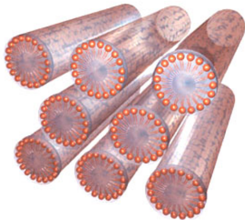
struttura tubolare ad impaccamento esagonale
